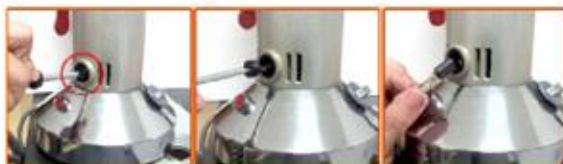
Замена угольной щетки
